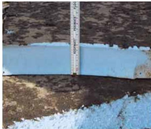
**Figura 7.** Perfil transversal de uma placa de isolamento ROOFMATE após 32 anos de serviço, numa cobertura invertida no exterior da camada à prova de água [Dow/FIW 2004],
